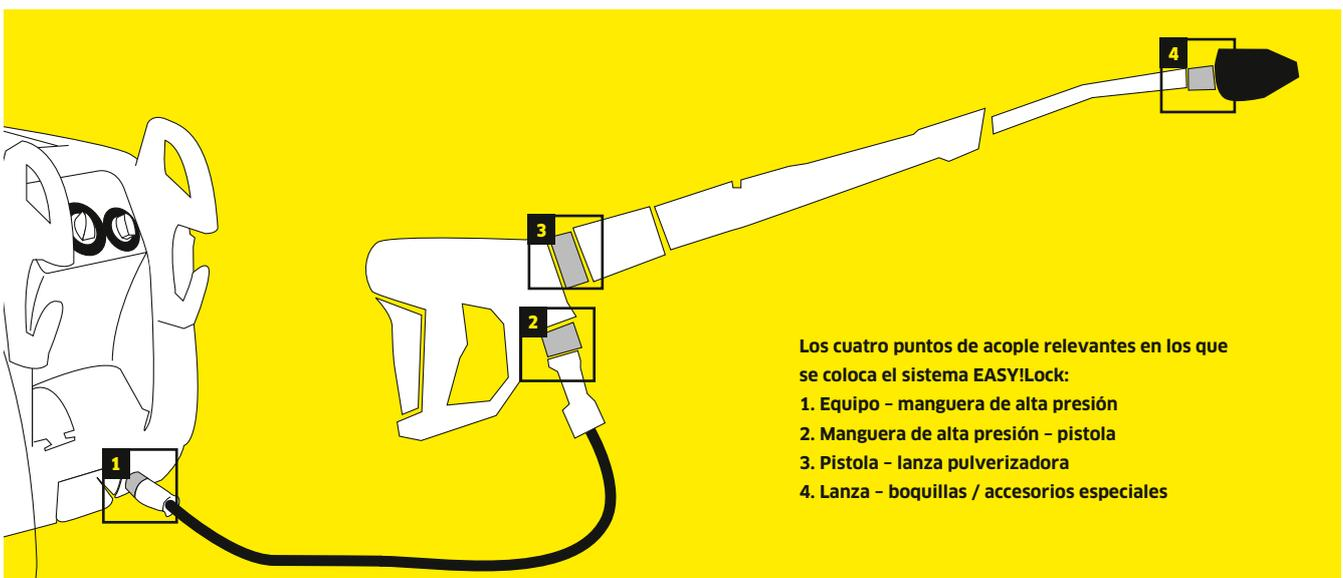
Los cuatro puntos de acople relevantes en los que se coloca el sistema EASY!Lock:
